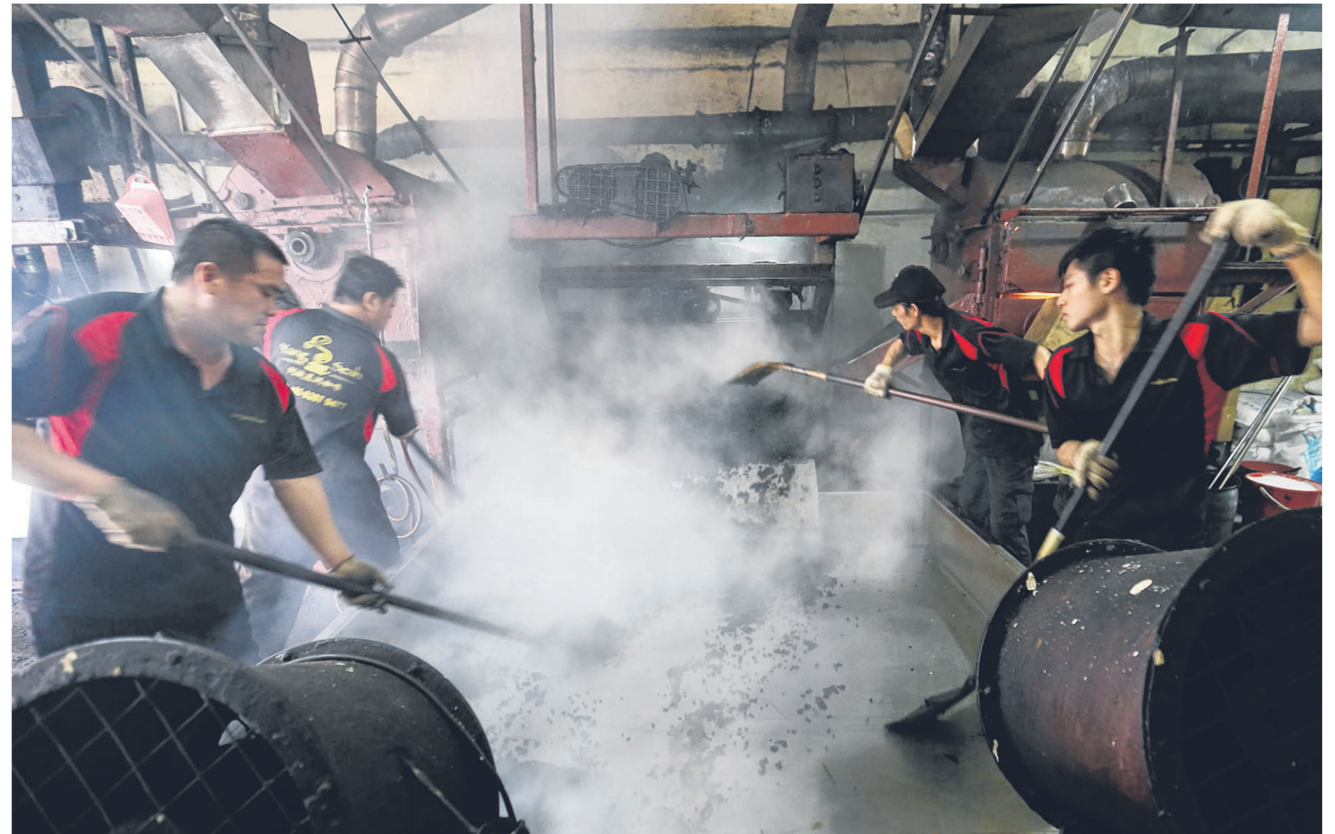
完成焦糖咖啡豆的工序后,须要进行强风冷却。这一道工序只能人工进行,机器难以取代。冷却的工序包括将经高温后融成一块的咖啡豆推松。
